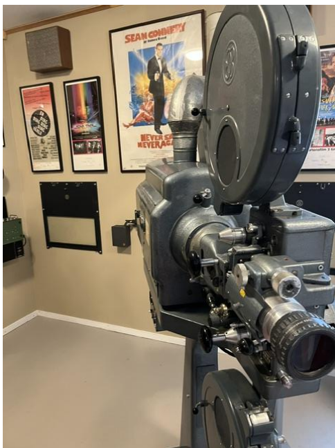
Klassisk bioprojektor med kolstål-svetslåga som ljuskälla ”brandfarlig”
