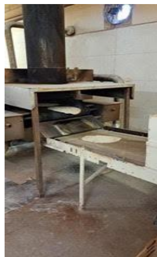
Tunnbrödet på väg i bakmaskinen
