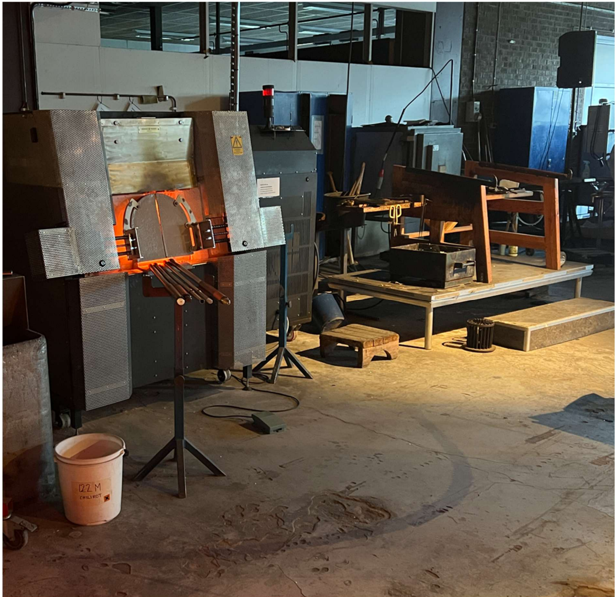
På kvällen skulle vi äta middag i en glashytta. Bilden visar den eldrivna ugnen där glasmassan ligger och väntar på att bli behandlad.
