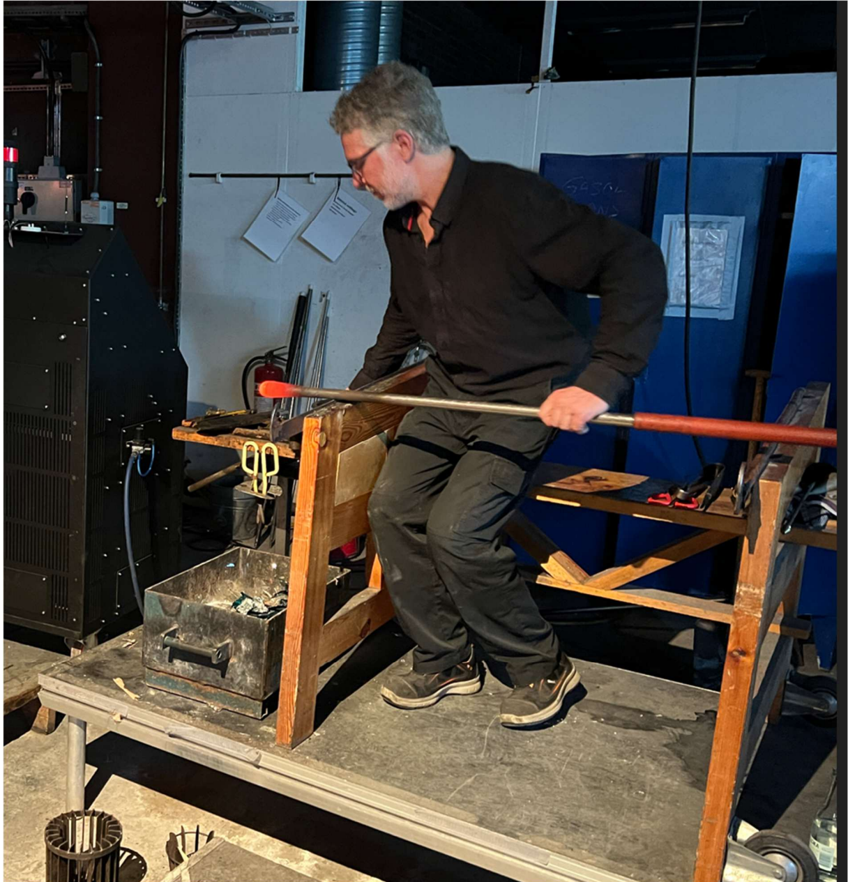
Här har han hämtat en bit glasmassa från en av ugnarna och skall börja bearbeta biten.
