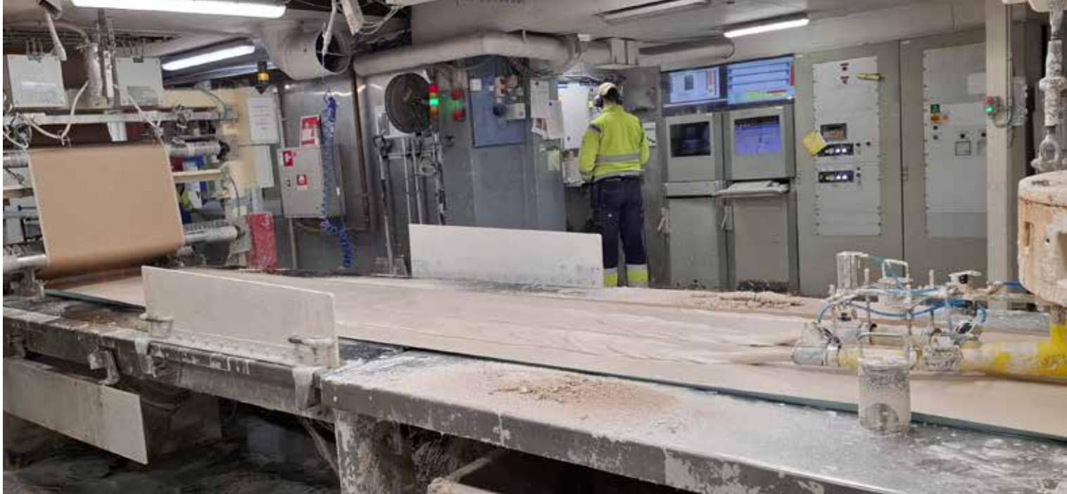
Till höger tillsätts flytande gips och till vänster formas skivan av papper och gips mellan valsarna.
