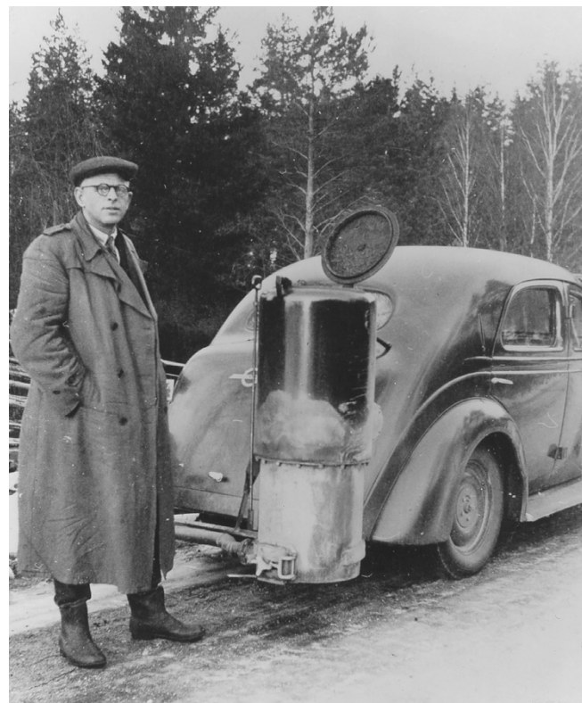
Gengasdriven bil 1944. Fotograf okänd. Bild från Wikipedia Commons.
