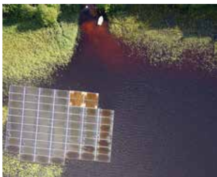
Sammanfatt flytram som lagts ut för att kväva sjögull vid badplatsen i Vita sjö. Flytramarnas totala yta är 830 m 2 .
