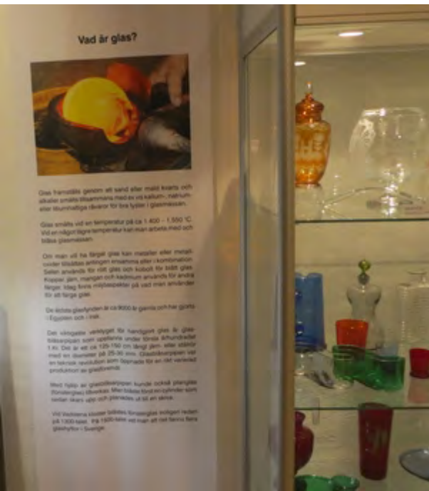
Vad är glas? Glas framställs genom att sand eller mald kvarts och alkalier smälts till-sammans med ex vis kalium-, natrium- eller litiumhaltiga råvaror för bra lyster i glasmassan.
