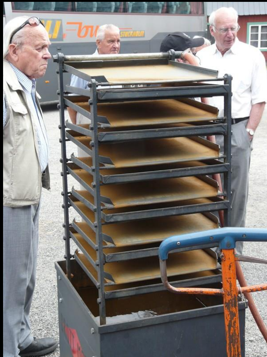
Anordning för kylning av kylvatten till motor.
